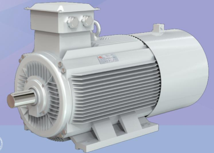
YE4VP系列变频调速三相异步电动机是根据国家政策和响应市场的需求,在2011年开发研制的高效变频调速电动机,其工频380V、50Hz的效率指标达到了国家中小型三相异步电动机能效限定值及能效级GB18613-2012的2级。它具有效率高、噪音低,振动小,调速范围广,运行可靠等优点。
